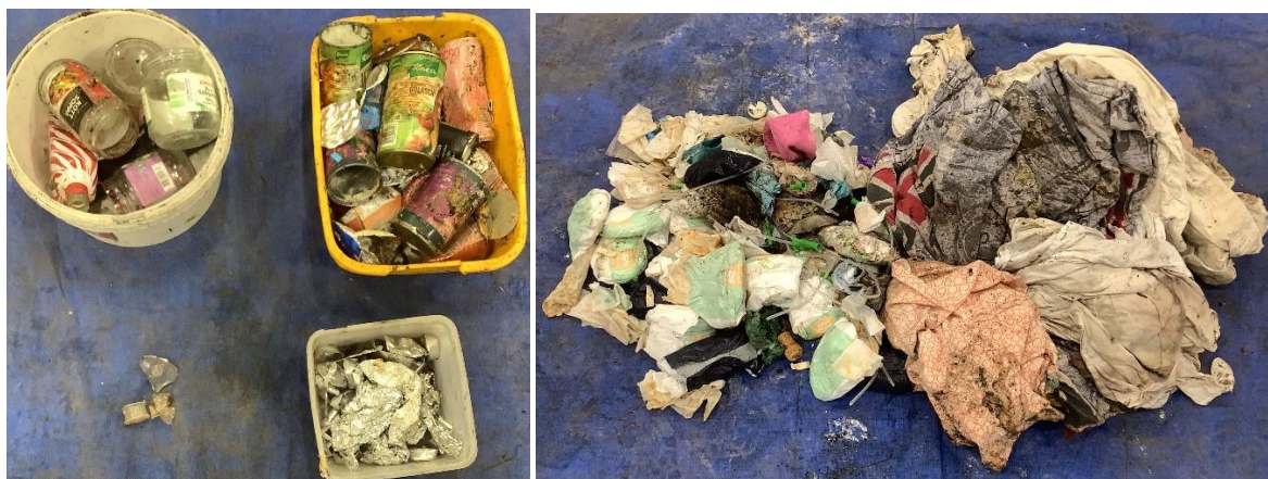
Bild 5.5 Metall- och glasförpackningar, övrig metall, övrigt glas (t.v.) samt övrigt brännbart (t.h.) från flerfamiljshushåll i Elseberg, 2024
